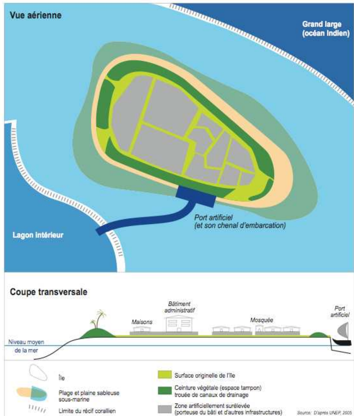
8. Schéma théorique d'une « île refuge » ou « safety island ».
